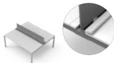
**Sistema abatible** que facilita el acceso directo a la bandeja de electrificación mediante el abatimiento de la tapa. Fabricado con el mismo material, su anchura y espesor es igual a la del sobre de la mesa, disponible en diferentes acabados. La tapa se abate hacia el usuario, mediante bisagras con 180° de recorrido. La profundidad de la tapa al sistema eléctrico es de 100 mm.
