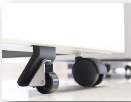
· **5<sup>a</sup> Rueda cajón archivador** : El cajón archivador dispone de rueda de refuerzo y estabilidad antivuelco. Rueda fija, de diámetro 30 mm. Montada sobre una horquilla de chapa de acero cincado y eje remachado. La rueda se suministra desmontada, estas se fijan a la estructura mediante tornillos.
